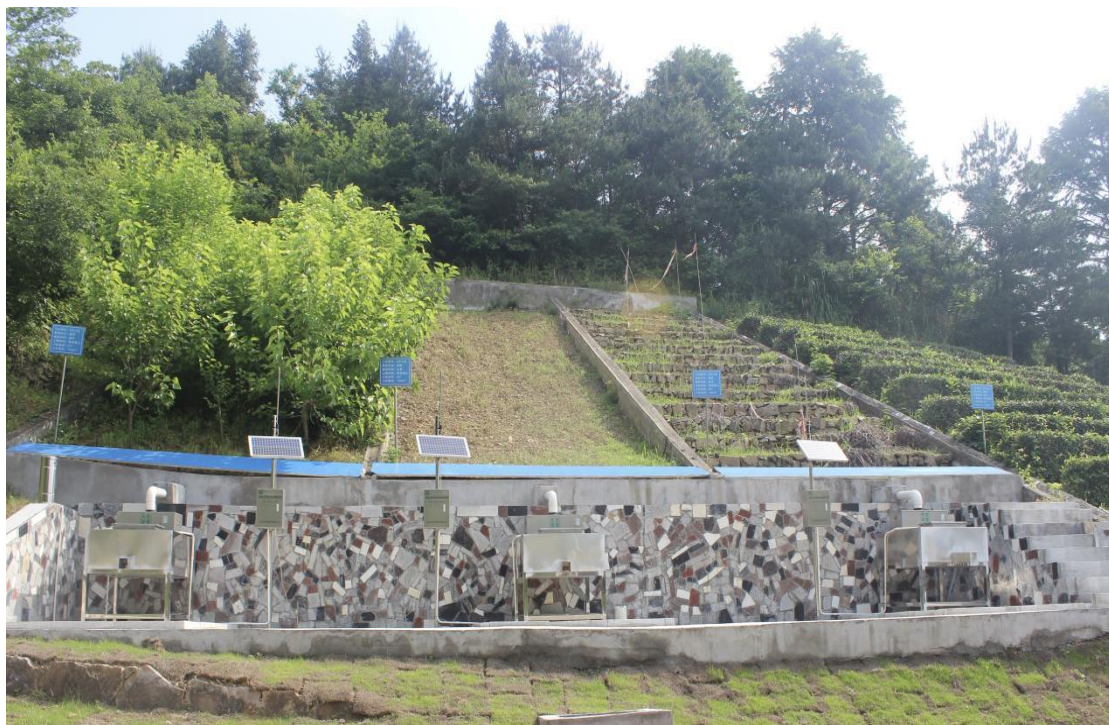
图4-1 霍山县江子河小流域坡面径流观测场
